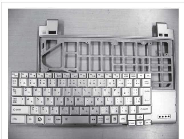
図10. 新構造による軽量キーボード— アルミ製バックプレートの薄肉化や、キーボードと本体カバーの一体成形による新構造で、軽量化を実現した。 New mechanical architecture of lightweight keyboard
