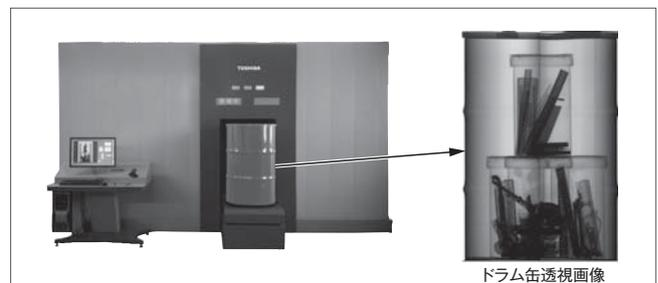
図7. カラー I.I.<sup>TM</sup>を用いた廃棄物容器の検査装置 — 独自のX線センサであるカラー I.I.<sup>TM</sup>に高画素ラインカメラを組み込むことで、ドラム缶を高解像度で透視撮影できる。
