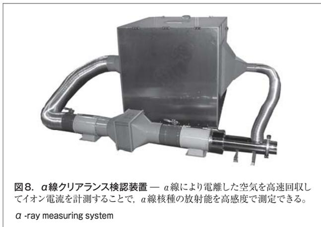
図8.  $\alpha$ 線クリアランス検認装置 —  $\alpha$ 線により電離した空気を高速回収してイオン電流を計測することで、 $\alpha$ 線核種の放射能を高感度で測定できる。
