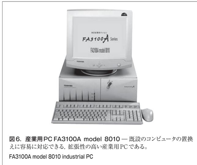
RAS機能を標準搭載し、システム異常の診断監視、復旧支援のほか、AC (交流) 電源断の際には内蔵UPSバッテリーに切り替えて自動シャットダウン処理を行う。
