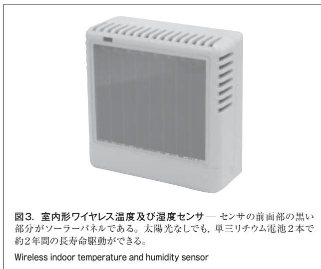
図3. 室内形ワイヤレス温度及び湿度センサ — センサの前面部の黒い部分がソーラーパネルである。太陽光なしでも、単三リチウム電池2本で約2年間の長寿命駆動ができる。
