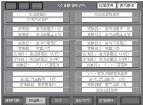
図6. 故障表示画面 — 装置に異常が発生した場合、故障内容を表示するとともに故障履歴を残すことができる。
