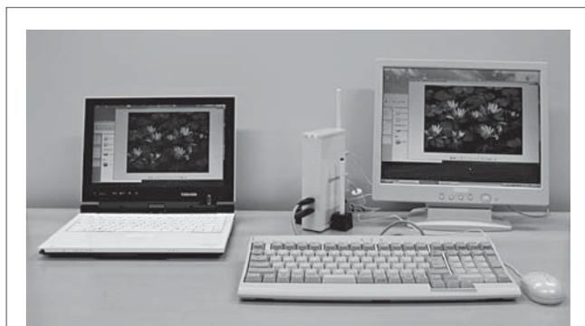
図7. ワイヤレスUWBポートリプリケータの使用例 — ノートPCのLCD画像が、中央のワイヤレスUWBポートリプリケータを介して外部ディスプレイに表示されている。ワイヤレスUWBポートリプリケータにはマウスとキーボードも接続されている。
