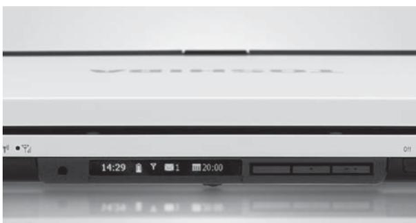
図2. PORTÉGÉ R400のAUX — 携帯電話のセカンドディスプレイに相当するAUXは、本体の正面下部に設置されている。
