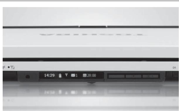
図4. 東芝エッジディスプレイ— 本体正面下部に、携帯電話のセカンドディスプレイに相当するエッジディスプレイを搭載している。
