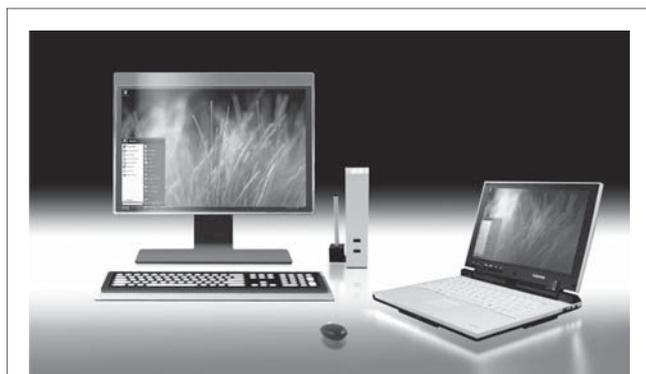
図5. ワイヤレスUWBポトリプリケータ — PORTÉGÉ R400では、机上の配置の自由度を上げるため、本体とポトリプリケータとの接続をワイヤレス化している。
