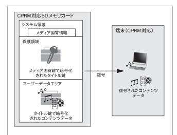
図3. SD-AudioにおけるCPRMの構成 — コンテンツはタイトル鍵とメディア固有鍵で2段に暗号化されている。
