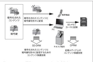
図1.  $MQbic_{TM}$ の概要 — コンテンツ配信の保護技術にSD-DRM, SDメモリカードでのコンテンツ保護にCPRMを採用している。 Overview of fields of application for  $MQbic_{TM}$
