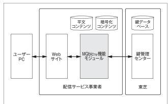
図4. デジタルコンテンツ配信システムの概要 — MQbic<sub>TM</sub>機能モジュールは、配信サービス事業者のシステムに組み込まれる。
