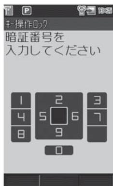
図8. “閉じたままロック解除”機能 — スライドを閉じたままでも、キー操作ロックを解除するための暗証番号を入力できる。
