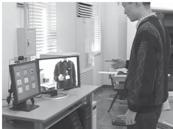
図1. HGUIシステム — ユーザーは、AV機器シミュレータの画面が表示されたモニタの前に立ってハンドジェスチャを行うことにより、映像の選択や再生などの操作を行うことができる。
