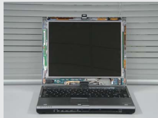
図2. 内蔵アンテナをノートPCのLCD周辺に実装 — LCD周辺にアンテナを実装するためには、アンテナの小形化が必須となります。
