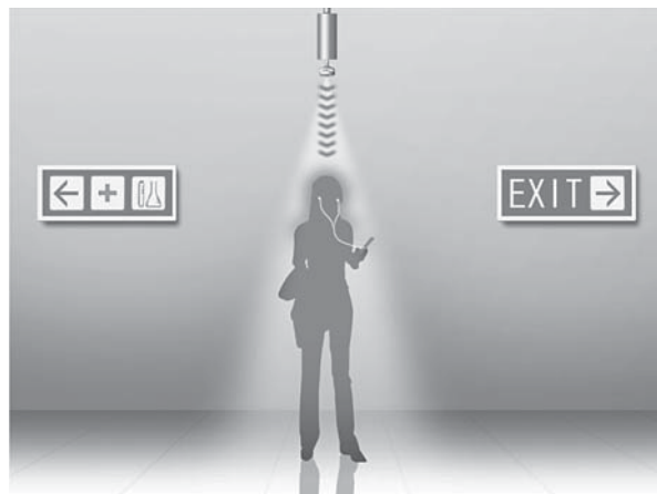
図10. 利用イメージ— スポットライト通信装置を取り付けた位置が情報の発信源となる。
