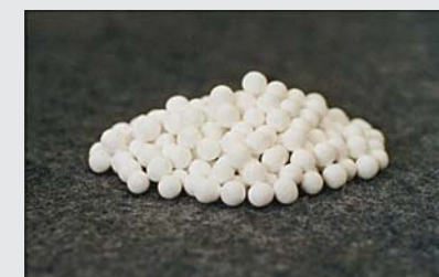
図3. リチウムシリケート — 主に使用している5 mmの球状ペレットです。必要に応じ、様々な形状で作ることができます。
