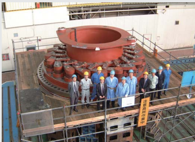
▲ 西龍池揚水発電所向けポンプ水車静止部の工場組立 Factory assembly of pump turbine for Xilongchi Pumped-Storage Power Station
