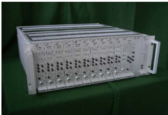
FPGA適用型 原子炉核計装監視装置 A-TOSDIA™ A-TOSDIA™ FPGA-based neutron monitor
