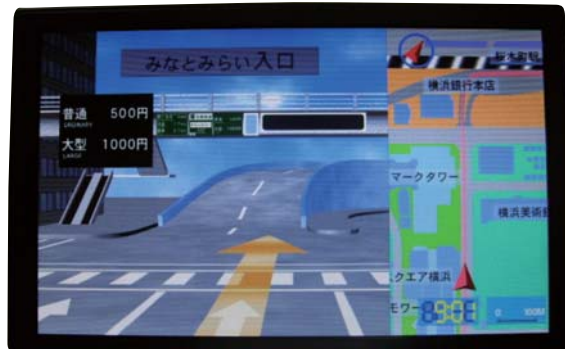
車載用 LEDバックライト付き 7型TFT-LCD
