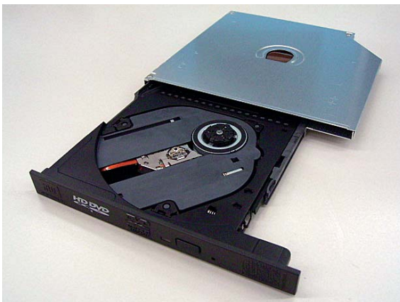
薄型HD DVD記録ドライブ SD-L902A SD-L902A slim type writable HD DVD drive
