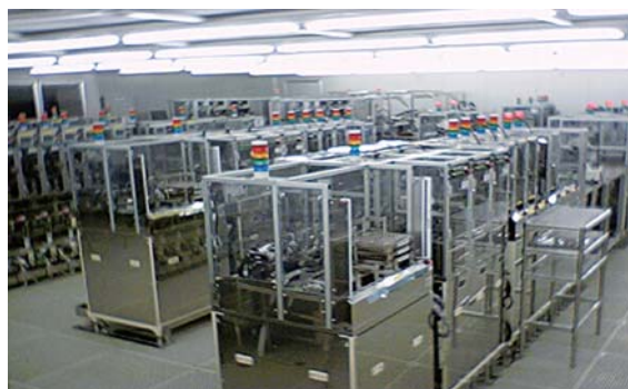
0.85インチHDD組立自動化ライン Automated assembly line for 0.85-inch hard disk drives
