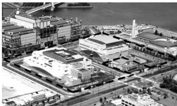
図 1. 大阪 PCB 廃棄物処理施設 一破線内の左側の建物 (西棟) に事務管理設備及び前処理設備、右側の建物 (東棟) に液処理設備が設置されている。
