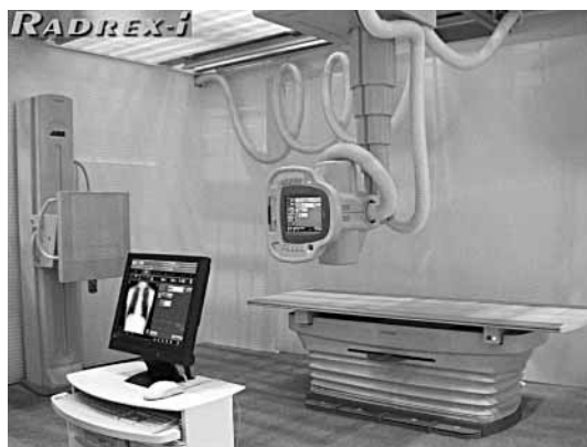
図1. FPDを搭載した静止画撮影システム — FPDシステムでは撮影直後に画像確認ができるので、患者拘束時間を短縮できる。
