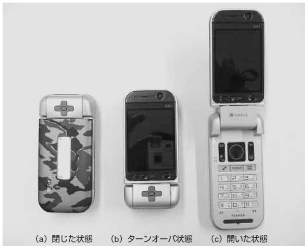
図1. 910Tの外観と多様なスタイル— 2.6型の大型LCDを搭載し、ヒンジ部にはサブマルチファンクションキーが配置されている。サブLCDは、13文字×2行表示のモノクロである。
