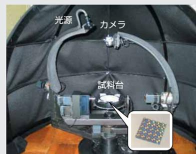
図2. 異方性をもった素材の撮影装置 — カメラや光源の位置を変化させ、様々な条件で実写することによって、見る方向や光の当たる方向に応じた素材表面の色変化を調べることができます。
