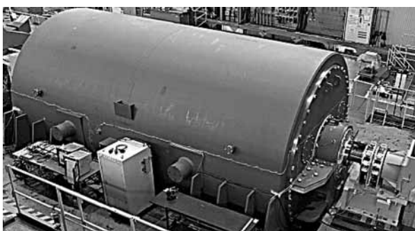
図1. 満州里向け発電機 — 満州里向け発電機の工場試験時のようすを示す。
