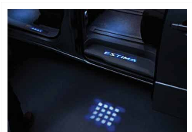
図2. ステップイルミネーション — スライドドアを開けると、足もとの路面とステップを照らす、斬新なイルミネーションである。
