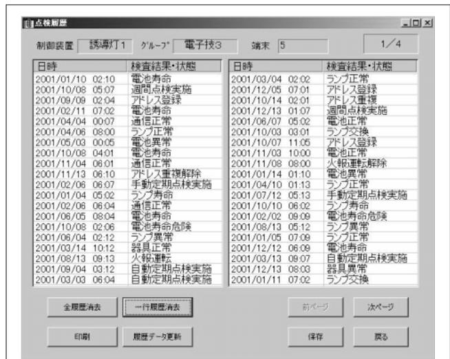
図5. 点検履歴のPC画面表示—異常発生や点検、部品交換の履歴が、新しいものから最大128件まで表示される。
