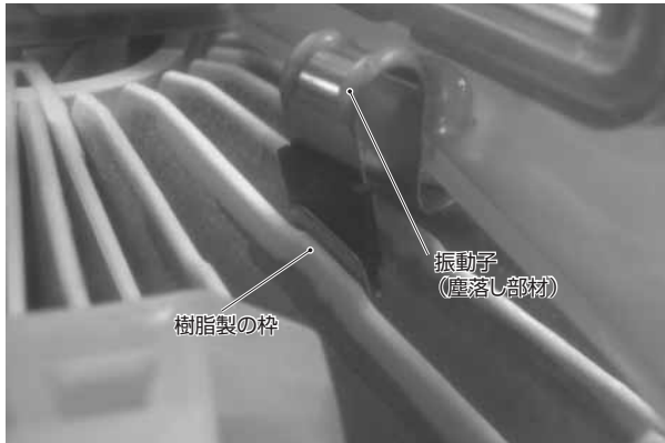
図4. フィルタと塵落し機構 — 塵落し機構は、ろ材を保持する樹脂製のフィルタ枠をステンレス製の振動子でたたく構造で、フィルタの上流側に配置している。
