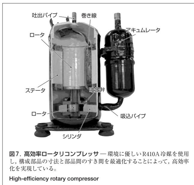
図7. 高効率ロータリコンプレッサ—環境に優しいR410A冷媒を使用し、構成部品の寸法と部品間のすき間を最適化することによって、高効率化を実現している。
