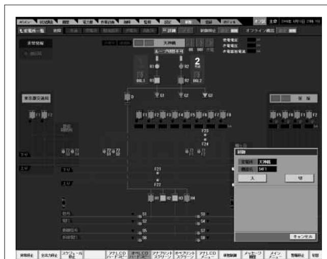
図6. 天神橋変電所のスケルトン画面 — 画面上の機器シンボルを選択することにより、単独制御することができる。
