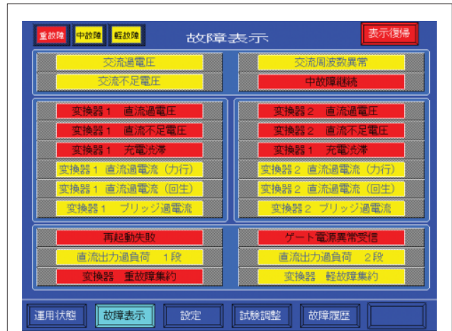
図9. 故障表示画面 — 装置に異常が発生した場合、故障内容を表示するとともに故障履歴を残す。
