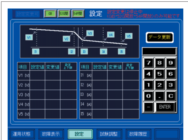
図8. 直流出力電圧レギュレーション特性の設定画面 — 力行側と回生側それぞれの動作開始電圧と電流をタッチパネルから入力できる。
