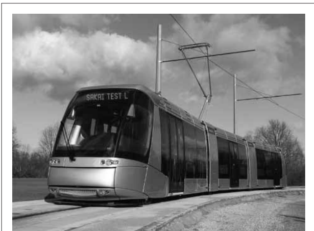
図1. トランスロール — ロールインダストリー社で試験走行中の、ゴムタイヤ式・低床式車両である。
