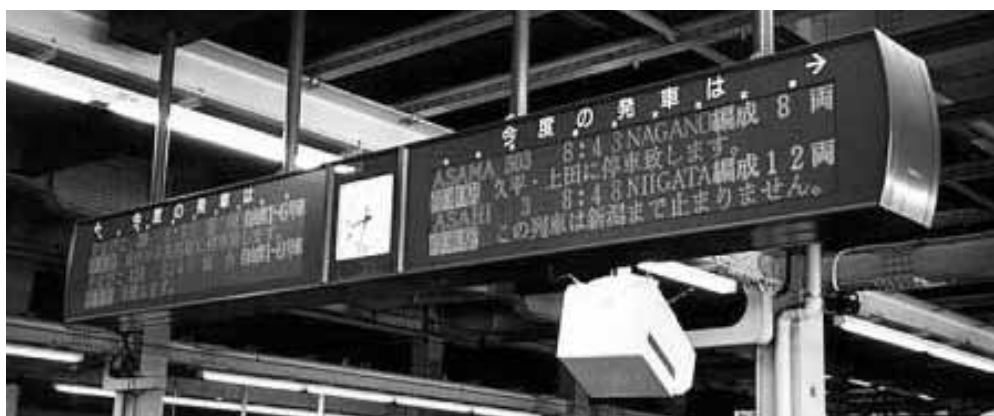
図1. LEDを応用した旅客案内表示器 — 駅のホームに設置されている旅客案内表示器で、行き先案内表示や時刻表示などを行う。
