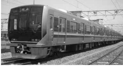
図1. 西日本旅客鉄道(株) 321系通勤形直流電車 — デジタル伝送装置を搭載している。 321 series commuter train of West Japan Railway Co.
