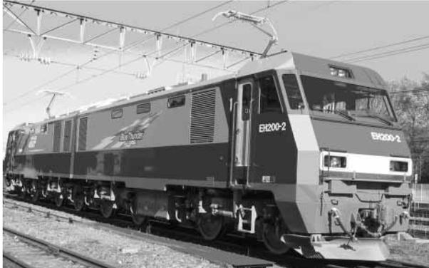
図8. EH200形 直流電気機関車 — 短時間最大出力5,120 kWを備える、直流電化こう配線区向けの直流電気機関車である。
