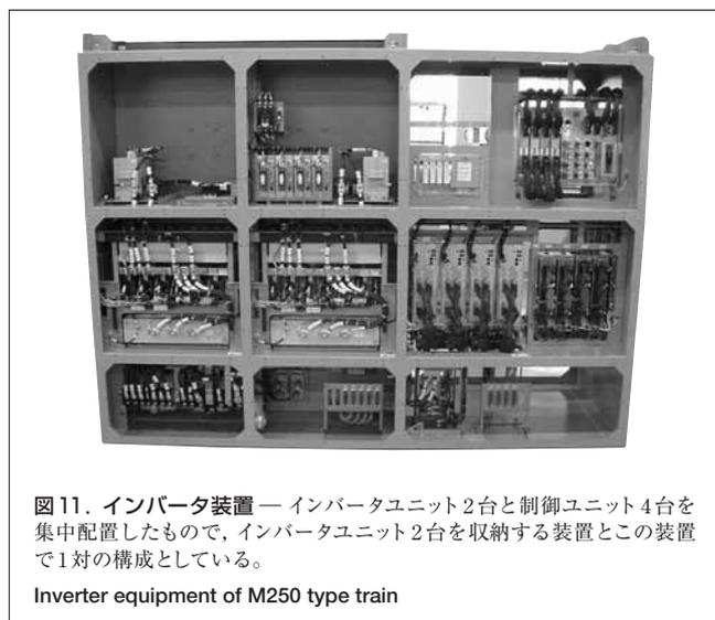
図11. インバータ装置 — インバータユニット2台と制御ユニット4台を集中配置したもので、インバータユニット2台を収納する装置とこの装置で1対の構成としている。
