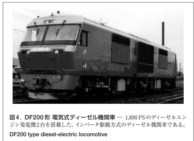
図4. DF200形 電気式ディーゼル機関車 — 1,800 PSのディーゼルエンジン発電機2台を搭載した、インバータ駆動方式のディーゼル機関車である。
