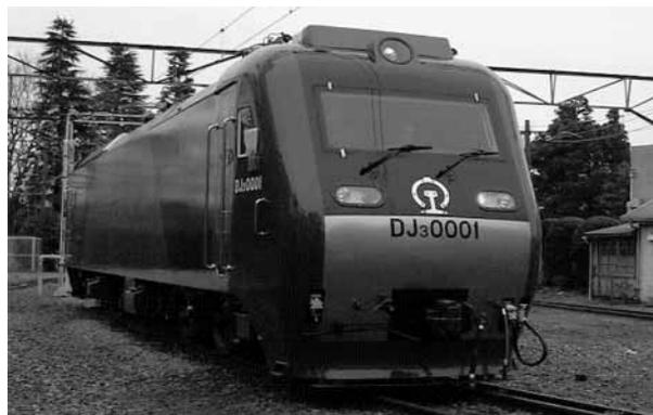
図 1. DJ3 形 交流電気機関車 — 交流架線 25 kV を電源とする、出力 7,200 kW の 6 軸機関車である。
