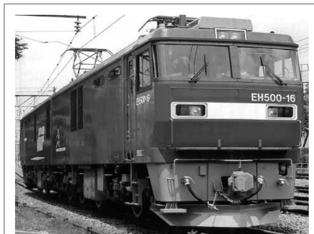
図6. EH500形 交直流電気機関車 — 4,520 kW(短時間)の出力を備え、青函トンネルの走行も可能な交直流電気機関車である。
