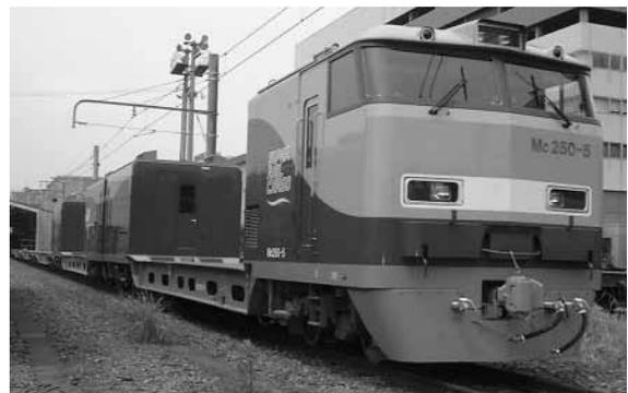
図10. M250系直流貨物電車 — 東京～大阪間を6時間10分で結ぶ、動力分散方式の貨物電車である。
