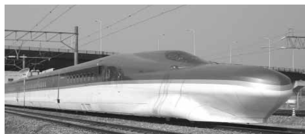
図7. E954形式 高速新幹線電車 (FASTECH360S) — 360 km/hでの営業運転を目指して、走行試験を実施中である。 E954 type (FASTECH360S) Shinkansen
