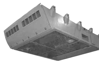
図4. N700系用主変換装置 — 700系用と比べて、約10%のパワーアップと軽量化を達成した。
