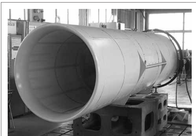
図8. 高風速型ジェットファンの試験風景 — 試作機による性能試験のようすを示す。
