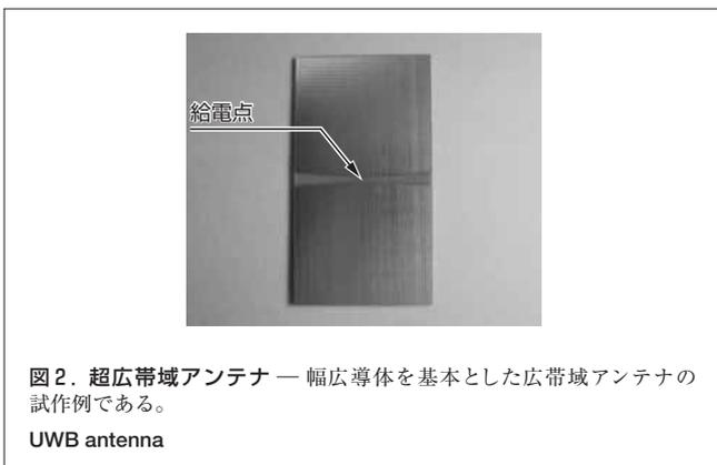
低周波においては、このまま拡大した相似形状を適用するのは困難である。例えば、500MHzにおいて $\lambda/2$ 波長=30cmのアンテナ長となり、携帯電話の上下基板そのものをアンテナとし、上下基板の中間点での給電構造を設ける必要があるなど、製品設計上克服しなければならない技術課題がある。
