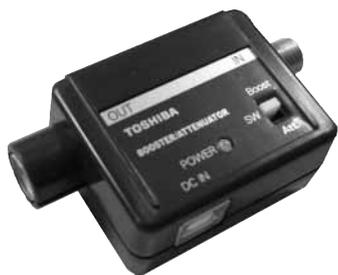
図6. 小型ブースタ/アッテネーター サイズは、25(高さ)×50(幅)×40(奥行き)mmである。
