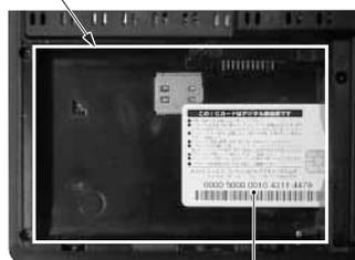
図6. B-CASカードの挿入口 — バッテリーパックを取り出すと、B-CASカードの挿入口がある。
