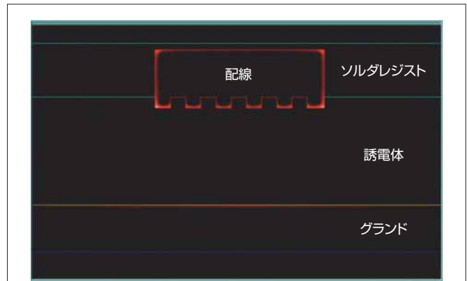
図8. 断面4の電流密度の解析結果 — 表皮効果により, 面積の小さいラフネスの突起部分に電流が集中していることがわかる。
