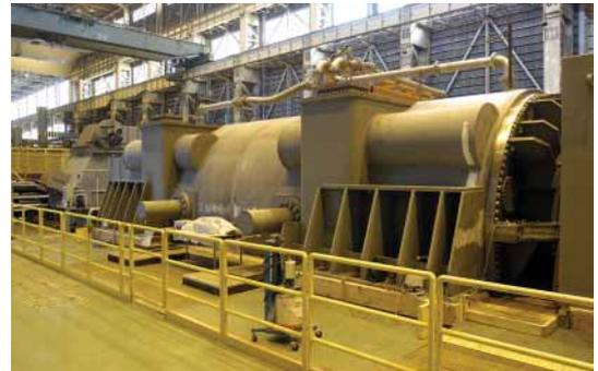
図3. 934,000 kVA 水冷却発電機の工場試験風景—出荷前に工場試験を実施し、仕様及び規格を満足していることを確認した。
