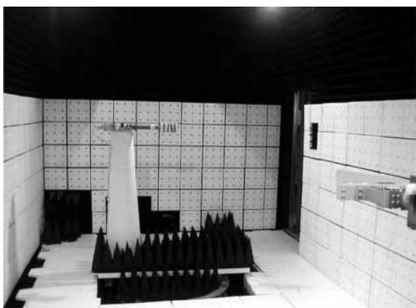
図5. 3次元放射特性測定装置 — 二つの回転軸を持った特殊な回転ジグを電波影響の少ない素材で構成した。
