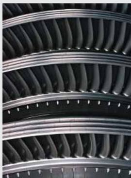
◀ 蒸気タービンの3次元設計翼に適用したスナバ翼列
