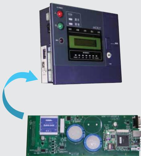
▲BACnet 対応 MCR27 (上) と BACnet 基板 (下)
