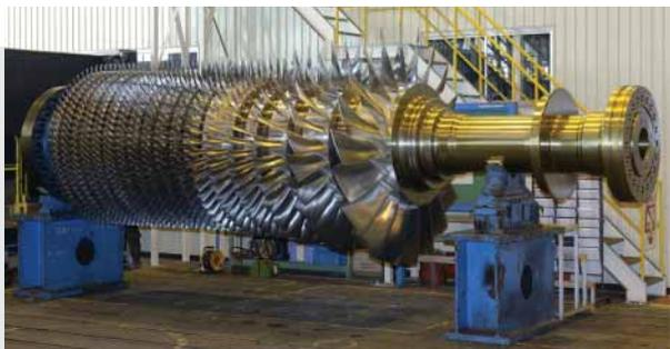
▲7H型ガスタービン用 空気圧縮機ロータ
