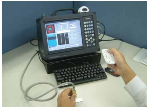
スポット溶接用超音波検査装置 Matrixeye™ Matrixeye™ ultrasonic inspection system for spot weld
