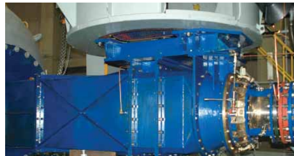
バルブ水車の模型試験装置 Bulb turbine model test stand
