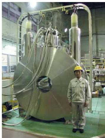
66 kV・1 kA級限流器用 高温超電導コイル
