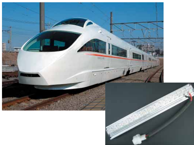
小田急電鉄(株) 新型特急ロマンスカーVSEのLED室内照明ユニット
