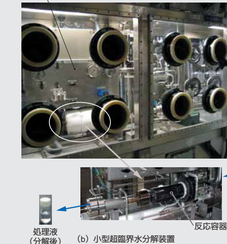
図5. 小型超臨界水分解装置 — 有機廃液を超臨界水中で完全に分解できます。
