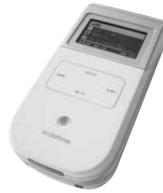
図4. 上筐体の背面側外観 — 音楽再生機能専用のモノクロLCDと操作ボタンを備え、音楽再生や楽曲選択を携帯電話を閉じた状態で行える。
