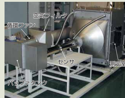
図2. 循環式イオン計測型αクリアランスレベル検査装置—測定室で発生したイオンをセンサに効率よく輸送するために、センサと測定室間の構造を最適化しました。
